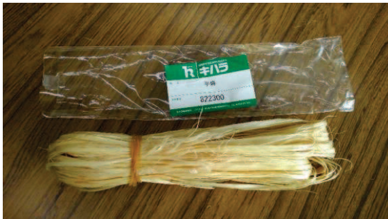
材(13b): 麻布(平麻)。糸のこ修理用 ほぐして糸のこ溝に埋める
